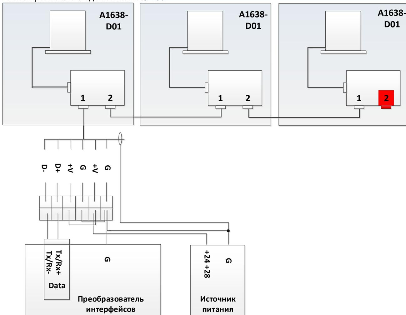
Рисунок 2 – Подключение сейсмоприемников A1638-D01 в измерительную линию
