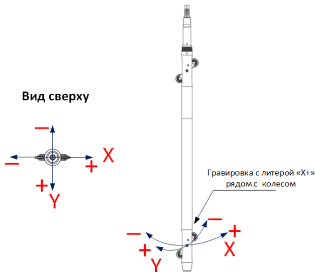
Рисунок.1.10 Направление измерительных осей инклинометра BIN-D3-50-20-YY-V
